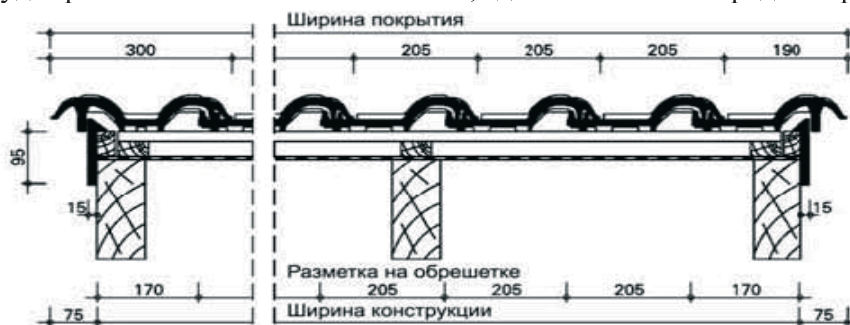
Рис. 25. Продольный разрез кровли с применением на фронте боковой черепицы (левой и правой).
