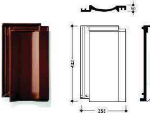
Рис. 14. План черепицы, поперечный и продольный разрезы.
